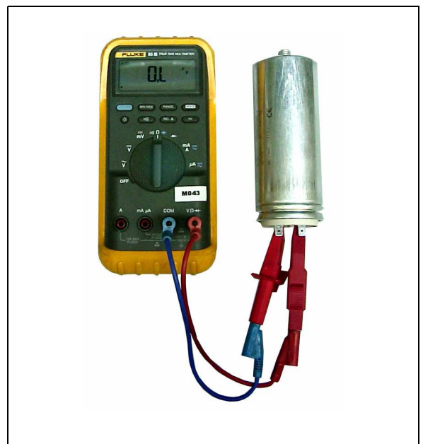
Fig. E.4.1-1: Checking capacitors
