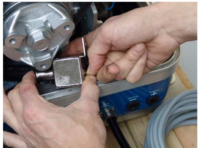
Fig. H.3-7: Remove Impellerfilter
